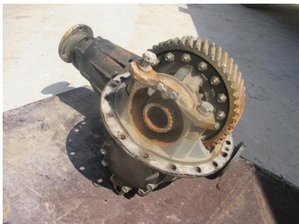
**Рис.2.** Дифференциал редуктора среднего моста
