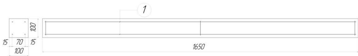
**Рис. 2.** Схема комбинированно-армированной балки:
