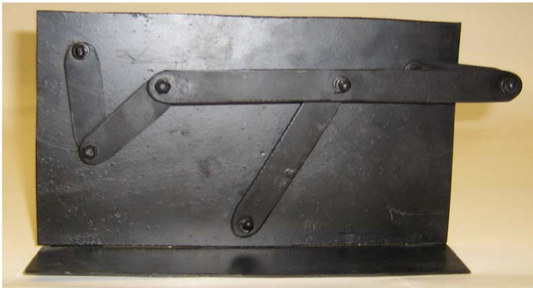
Рис. 3. Модель шестизвенного шарнирно-рычажного механизма
