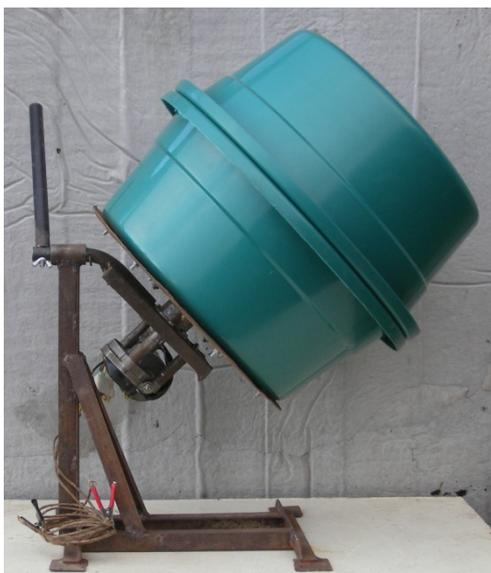
**Рис. 2.** Бетоносмеситель – БС-52П: объём барабана – 52 литра; масса одного замеса до 55 кг; производительность – 1,5 т/ч; мощность двигателя – 40 Вт; напряжение – 12 V; масса – 16 кг; число деталей – 18
