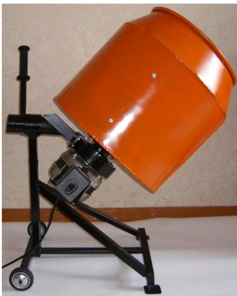
**Рис. 1.** Бетоносмеситель – БС-60М: объем барабана – 60 литров; масса одного замеса до 70 кг; производительность – 2 т/ч.; мощность двигателя – 180 Вт; напряжение – 220 V; масса – 22 кг; число деталей – 28
