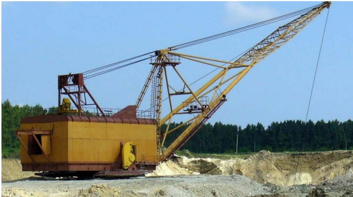
**Рис. 2.** ЭШ кривошипно-шарнирный с треугольной рамой механизма шагания
