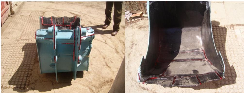
**Рис. 9.** Повреждения и разрушения, наблюдаемые в ковше в условиях эксплуатации: красные линии – зоны повреждения
