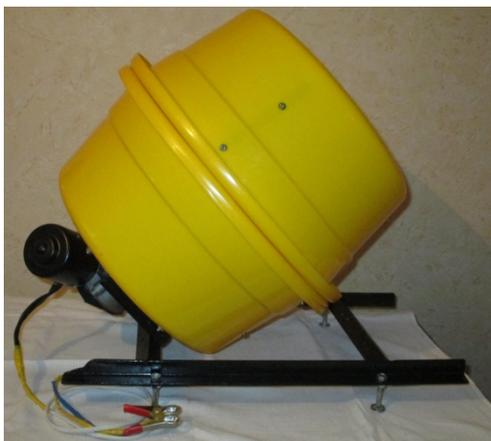
**Рис. 3.** Бетоносмеситель – БС-38П: объём барабана – 38 литров; масса одного замеса до 40 кг; производительность – 1 т/ч.; мощность двигателя – 40 Вт; напряжение – 12 V; масса – 8 кг; число деталей – 8
