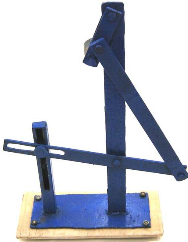
**Рис. 6.** Пятизвенный кривошипно-ползунный механизм
