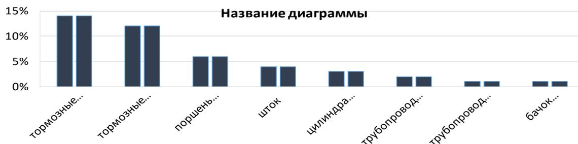
**Рис. 2.** Статистика отказов конструктивных элементов тормозной системы автомобиля в гарантийный период
